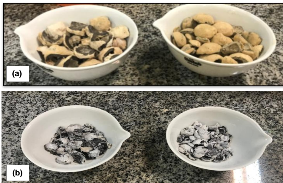
Figura 3. Biomassa (endocarpo da macaúba) (a) antes da carbonização e (b) após a carbonização.
